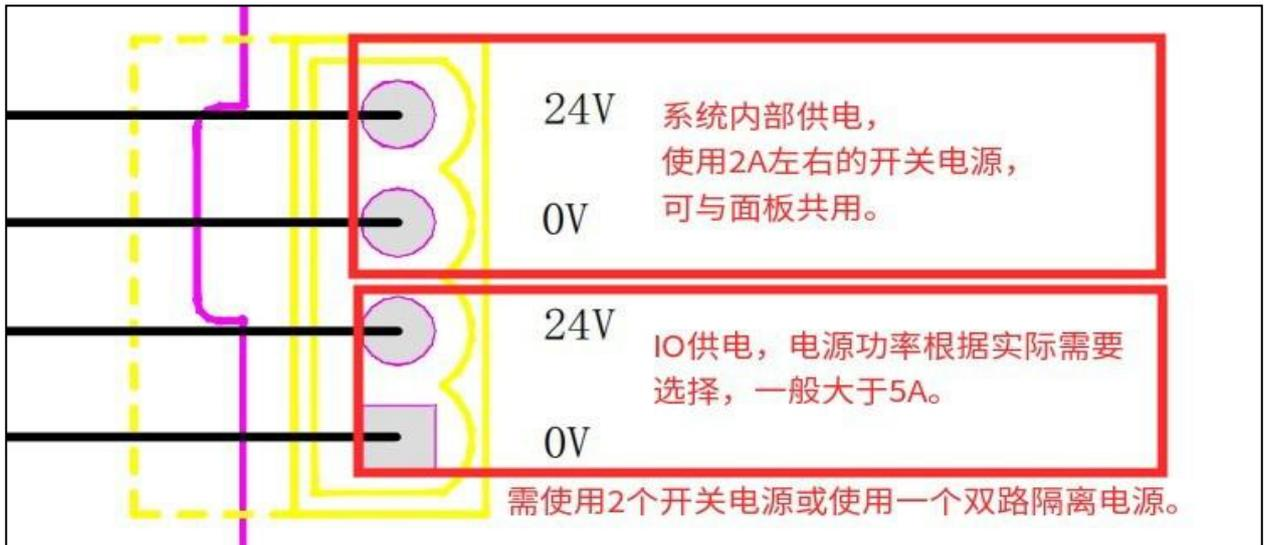
图 2 主机电源接线要求
