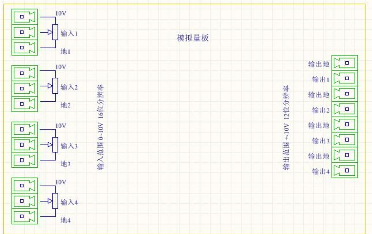
图 9 模拟量板接口定义
