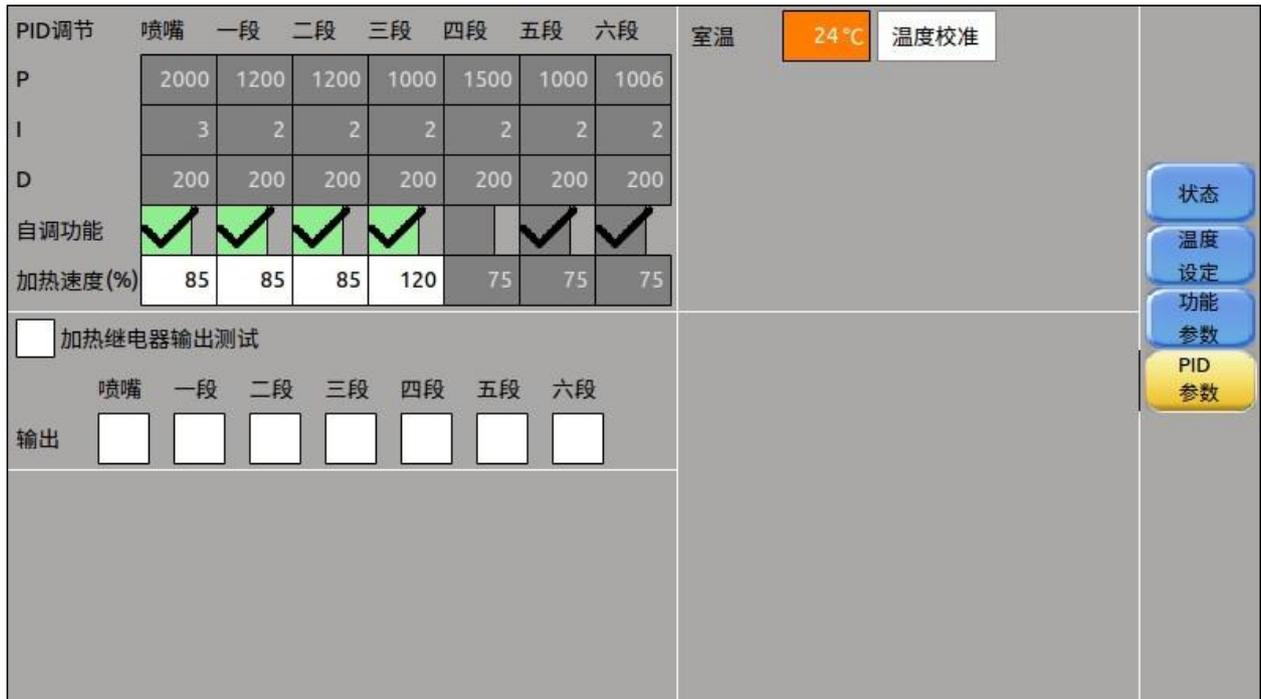
图 42 温度 PID/吹风/参数页面
