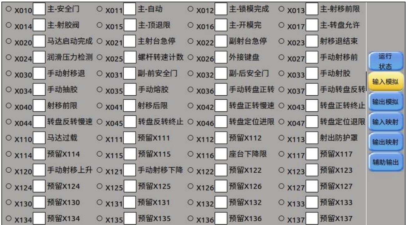
图 53 IO 输入模拟页面
